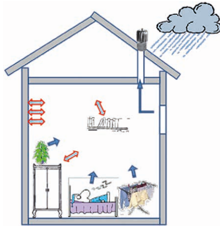
Fig. 7.19. Componentes del equilibrio higroscópico de una habitación en una vivienda: producción interna de humedad, la ventilación, el clima interior y exterior y el buffering en los materiales superficiales de la envolvente y mobiliario. Fuente: Iñaki Gómez Arriaran, Tesis Doctoral.
